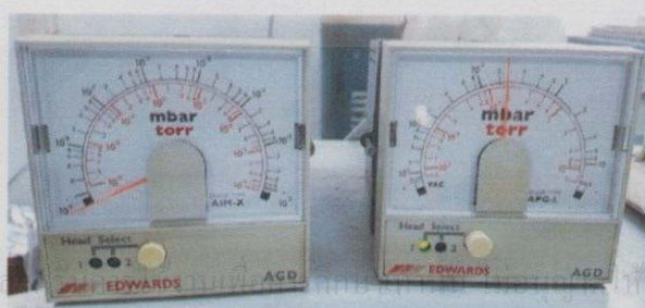
รูปที่ 3.46 เครื่องอ่านความดันภายในภาชนะสุญญากาศแบบเข็ม
