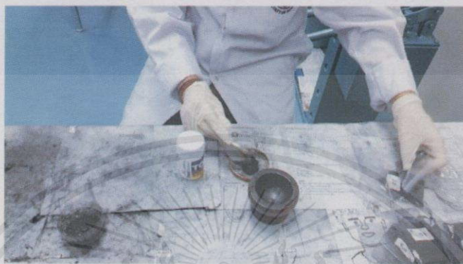
รูปที่ 3.16 แสดงวิธีผสมผงสารกับกาวลาเท็กซ์บนภาชนะใส่ผงสารที่เตรียมไว้
