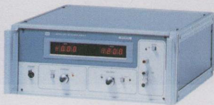
รูปที่ 3.14 แหล่งกำเนิดแรงดันไฟฟ้ากระแสตรง ยี่ห้อ Good will Model GPR-60H15
