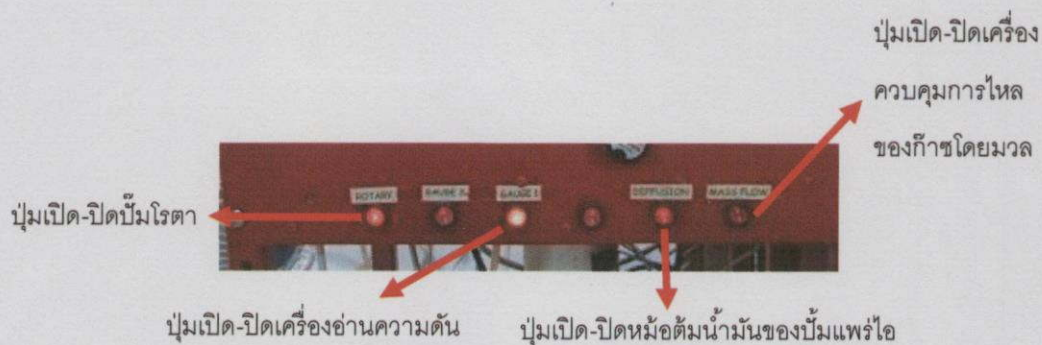
รูปที่ 3.44 แสดงปั๊มเปิด-ปิดของอุปกรณ์ส่วนต่างๆของระบบดีซีแมกนีตรอนสปัตเตอร์
