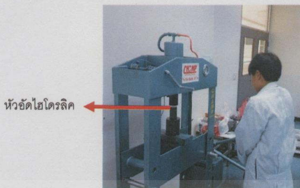
รูปที่ 3.18 แสดงตำแหน่งการวางเบ้าอัดสารบนแท่นอัดไฮโดรลิก
