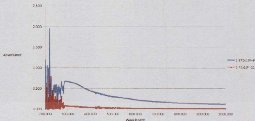
รูปที่ 4.3 กราฟเปรียบเทียบค่าการดูดกลืนของควอนตัมดอทที่ถูกเจือจางจนมีความเข้มข้น 1.875 \times 10^{-9} โมล/ลิตร และ 3.75 \times 10^{-11} โมล/ลิตร
