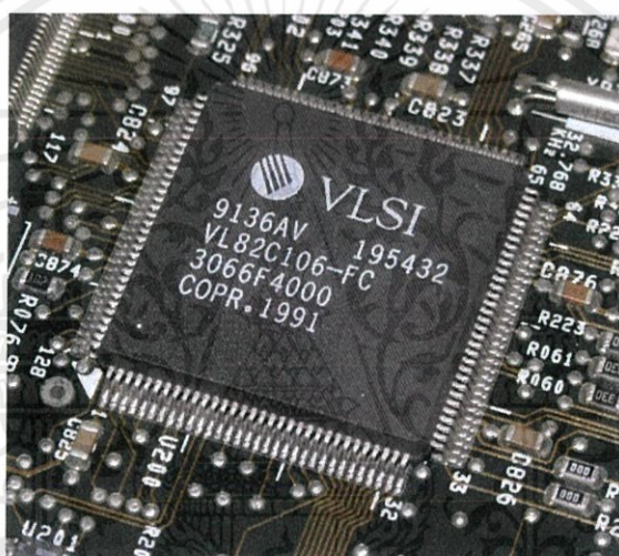
รูปภาพ 7 VLSI (Large Scale Integrated Circuit)
