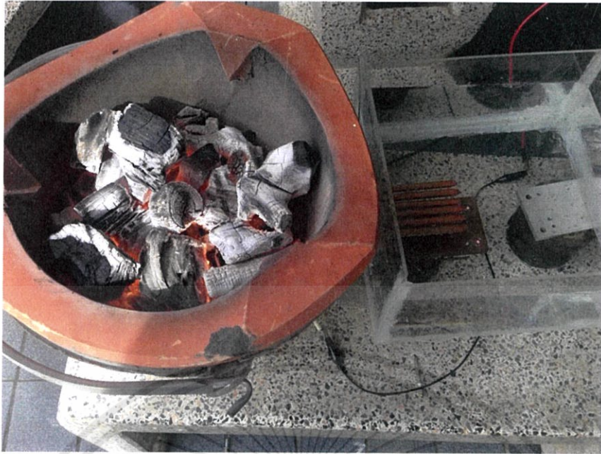
รูปที่ 4.19 ชุดระบบระบายความร้อนของฮีทไปป์ร่วมกับถังน้ำ ที่ติดเข้ากับเตาหุงต้ม
