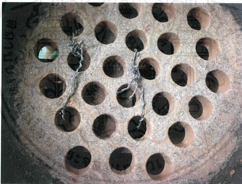
รูปที่ 4.18 แผ่นทองแดงทางด้านร้อนของชุดระบบระบายความร้อนที่ติดเข้ากับบริเวณด้านล่างรังผึ้งของเตาหุงต้ม
