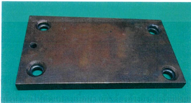
รูปที่ 3.14 ชิ้นงานแผ่นทองแดง( ส่วนปิดทับเทอร์โมอิเล็กทริกโมดูล )ที่ทำการเจาะรูเรียบร้อยแล้ว
