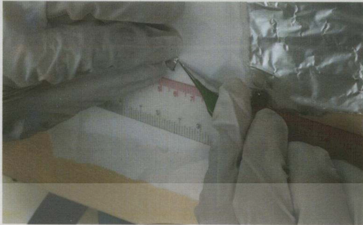
รูปที่ 7 สารมาตรฐานขณะทำการห่อสารด้วยอลูมิเนียมและเปิดมุมทั้งสองเพื่อเตรียมการทำจุดสัมผัส
