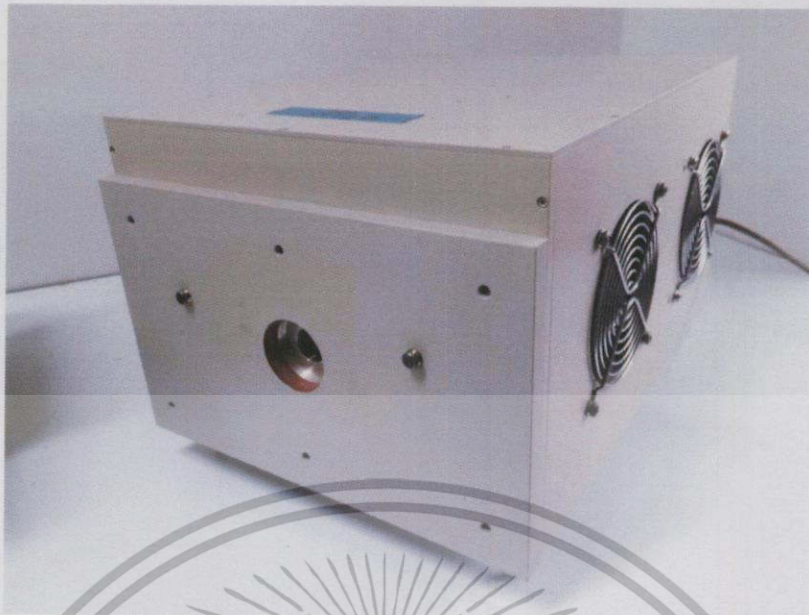
รูปที่ 3.2 แหล่งกำเนิดแสง Xenon lamp ขนาด 450 วัตต์
