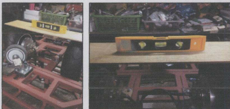
รูปที่ 3.11 ตั้งศูนย์ และระดับล้อย โดยใช้เครื่องวัดระดับน้ำ
