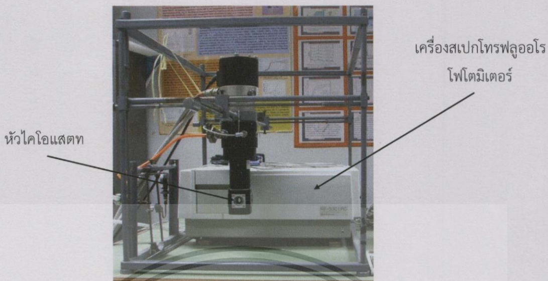
รูปที่ 3.3 แสดงภาพถ่ายเครื่องสเปกโทรฟลูออโรโฟโตมิเตอร์ยี่ห้อ Shimadzu รุ่น RF-5301PC
