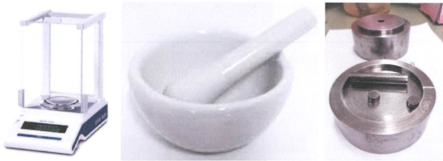
รูปที่ 3.1 แสดงอุปกรณ์ที่ใช้ในการเตรียมเม็ดเซรามิกของสารกึ่งตัวนำ W_{1-x}In_xO_3 (4 at.%) ที่เตรียมจากสารตั้งต้นที่เป็นผงผลึกโดยวิธีปฏิบัติการเกิดเป็นสารละลายของแข็ง
