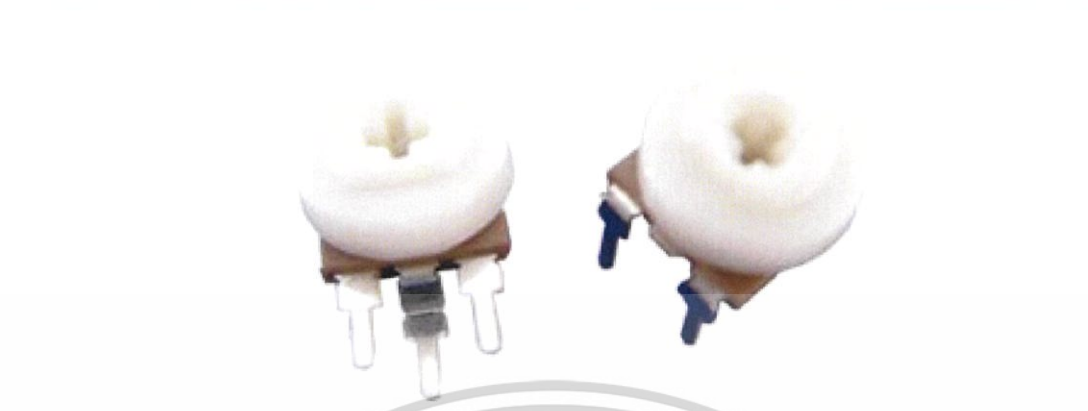
รูปที่ 3.2.5 ตัวต้านทานปรับค่าได้ (Potentiometer)
