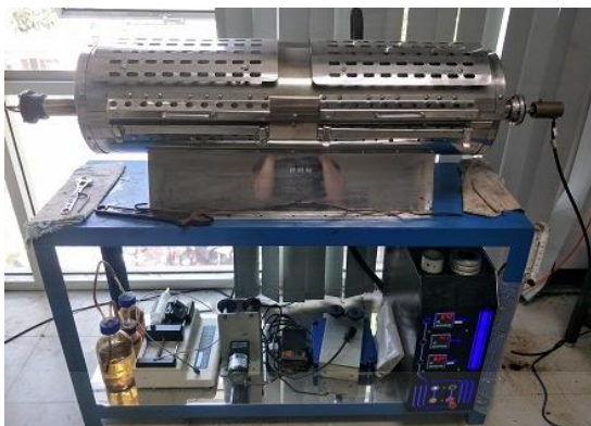
รูปที่ 3.9 เตาเผาสำหรับการคาร์บอนเซชันภายใต้บรรยากาศไนโตรเจน
