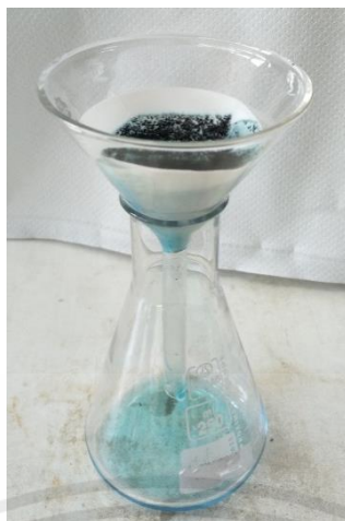
รูปที่ 3.13 แสดงการกรองสารด้วยกระดาษกรองเบอร์ 1 และลักษณะของสารตัวอย่างที่ได้หลังจากการดูดซับด้วยสีย้อมเมทิลีนบลู (จากซ้ายไปขวา)
