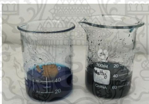
รูปที่ 3.12 แสดงลักษณะของเส้นใยนาโนคาร์บอน 0.3 กรัม ที่ความเข้มข้น 50 และ 100 มิลลิกรัมต่อลิตร เวลา 10 และ 15 นาที (จากซ้ายไปขวา)
