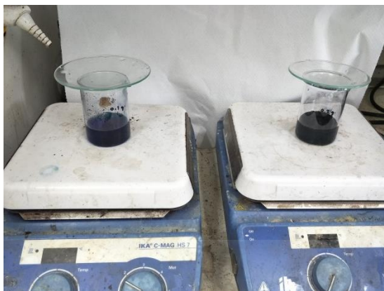
รูปที่ 3.11 แสดงลักษณะของเส้นใยนาโนคาร์บอน 0.1, 0.2, และ 0.3 กรัม ที่ความเข้มข้น 25 มิลลิกรัมต่อลิตร เวลา 5 นาที
