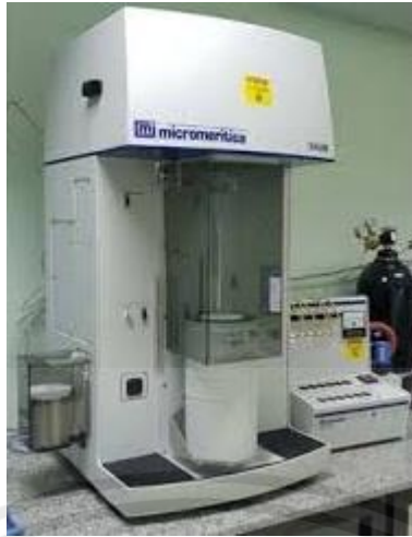
รูปที่ 2.18 แสดงเครื่องวิเคราะห์ขนาดพื้นที่ผิวจำเพาะและปริมาตรรูพรุน
