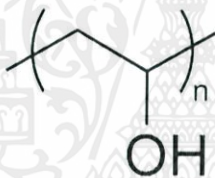
รูปที่ 2.7 โครงสร้างทางเคมีของพอลิไวนิลแอลกอฮอล์
