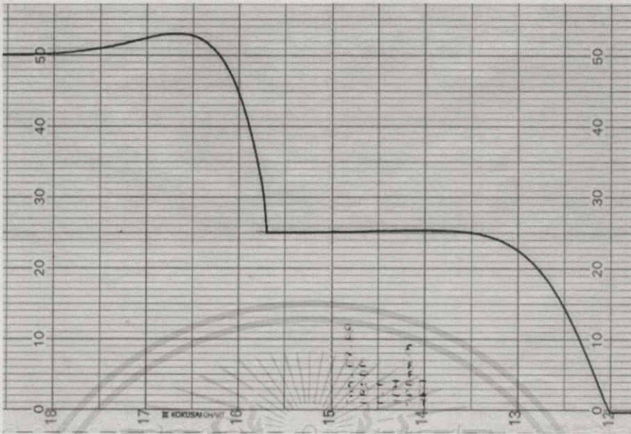
รูปที่ 5.9 แสดงผลตอบสนองของกระบวนการควบคุมระดับของน้ำในถังที่ค่าเป้าหมาย 25% และ Step Change ไปที่ 50% ด้วยการควบคุมแบบ PID ตามวิธีของ Dahlin ( K_c = 0.9 , T_i = 145 sec. และ T_d = 11 sec.) ความเร็วการบันทึก 360 mm./h.
