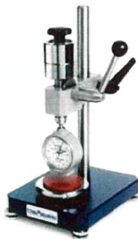
รูปที่ 3.3 เครื่องทดสอบความแข็งกดแบบคูโรมิเตอร์ชนิดซอร์ A ตามมาตรฐาน JIS K 6253 [34]
