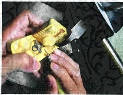
รูปที่ 1.1 ตัวอย่างแม่พิมพ์ยางสำหรับอุตสาหกรรมเครื่องประดับ
