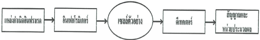
รูปที่ 3.7 แสดงส่วนประกอบและลำดับการทำงานของเครื่องตรวจวัด[Air Quality Analytical (Gasmeter-USA)2005]
