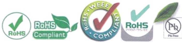
รูปที่ 2.20 แสดงภาพสัญลักษณ์ระเบียบว่าด้วยการห้ามใช้สารอันตรายบางชนิดในผลิตภัณฑ์ไฟฟ้าและอิเล็กทรอนิกส์ (RoHS) ที่อาจพบเห็นบนกล่องผลิตภัณฑ์ [12]
