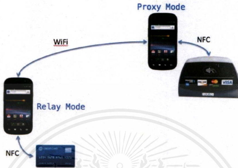
รูปที่ 2.5 ตัวอย่างการโจมตีแบบ Relay Attack (ที่มา : NFCProxy)
