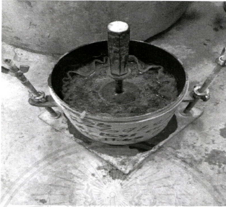
รูปที่ 3.11 ใส่ดินลงไปให้ได้ระดับ 11 ซม. วางแผ่นผ้าใยสังเคราะห์อีกชั้นแล้วตามด้วยน้ำหนักกดทับ
