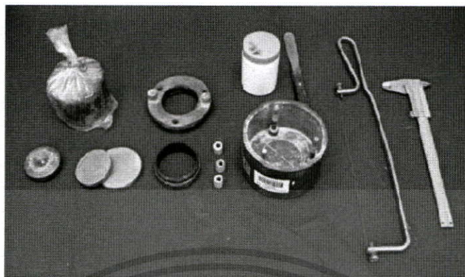
รูปที่ 2.7 อุปกรณ์การทดสอบการยุบอัดตัวของดิน
