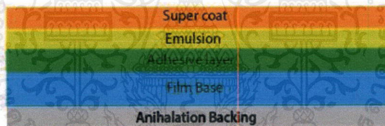
รูปที่ 2.3.2 แสดงภาคตัดขวางของฟิล์มเอกซเรย์แบบ Single Emulsion
