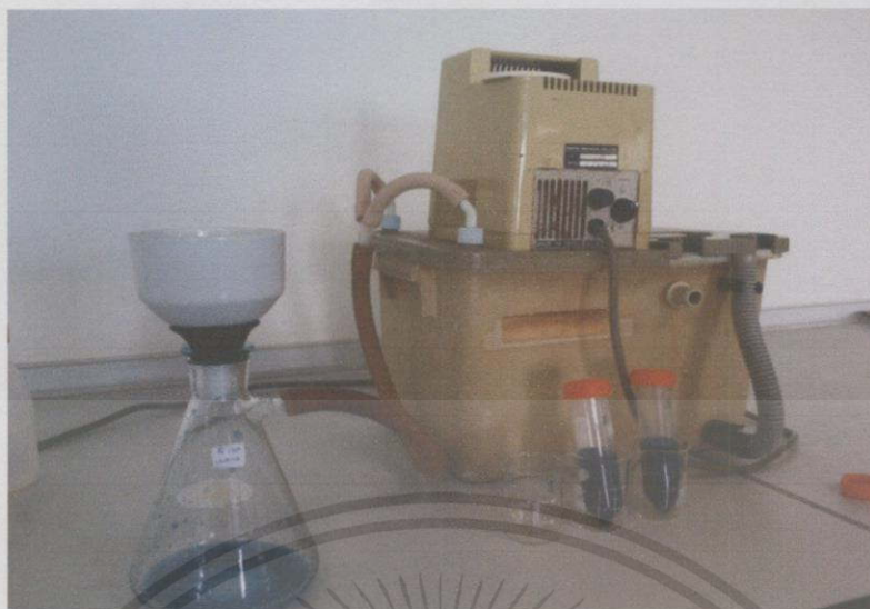
รูปที่ ข-5 เครื่องกรองสุญญากาศ (Suction pump) รุ่น Aspirator A-3s ยี่ห้อ Eylea เครื่องกรองสุญญากาศใช้กรองเอาสารละลายสีข้อม เพื่อไปวัดค่าการดูดกลืนแสงโดยมีการเจือจางสารละลายสีข้อมรีแอกทีฟ แบล็ค 5 ด้วยน้ำกลั่น ก่อนการนำไปวัดค่าการดูดกลืนแสง
