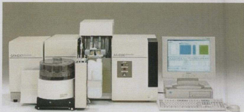
รูปที่ 3.12 เครื่องอะตอมมิคแอบซอร์พชันสเปกโตรมิเตอร์ [26]
