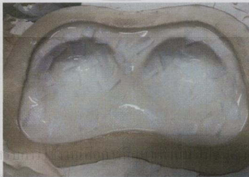
รูปที่ 3.8 การวางผ้าซับยางบนผิวของซิลิโคน
