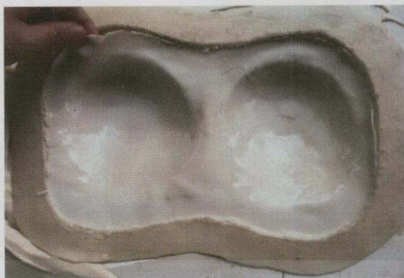
รูปที่ 3.10 แสดงชั้นยางซิลิโคนเหลวที่แข็งตัวแล้ว
