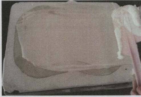
รูปที่ 3.7 การปาดฟองผิวหน้าแม่พิมพ์ให้เรียบ
