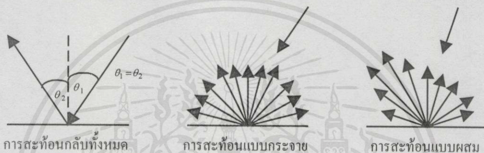
รูปที่ 2.4 เปรียบเทียบปรากฏการณ์การสะท้อนแสงในลักษณะการสะท้อนกลับหมด การสะท้อนแบบกระจาย และการสะท้อนแบบผสม
