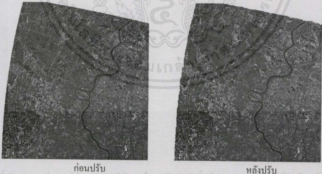
รูปที่ 4.17 เปรียบเทียบผลลัพธ์ที่ได้จากการปรับแก้ความเพี้ยนเชิงเรขาคณิตและภาพผลลัพธ์ที่ได้จากการแทรกค่าด้วยวิธีคิวบิกสไปน์แบบ Clamped boundary ในภาพ MOS-1 แบนด์ที่ 1
