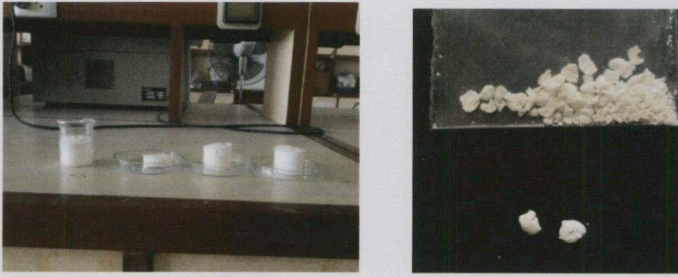
รูปที่ 2.1 แสดงลักษณะของ polyHIPEs ชนิดก้อน (ซ้าย) และชนิดเม็ด (ขวา)
