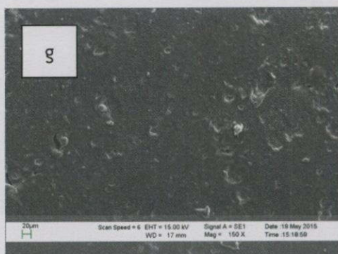
รูปที่ 4.8 ภาพถ่ายจากกล้อง SEM กำลังขยาย 150 เท่า (a) NR, (b) NR+TiO 2 , (c) NR+TiO 2 +GO 2 mg, (d) NR+TiO 2 +GO4 mg, (e) NR+TiO 2 +GO6 mg, (f) NR+TiO 2 +GO8 mg และ (g) NR+TiO 2 +GO10 mg
