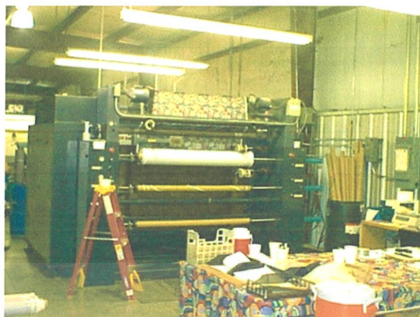
ภาพที่ 2.92 เครื่องพิมพ์ลายลงกระดาษ Heat Transfer
