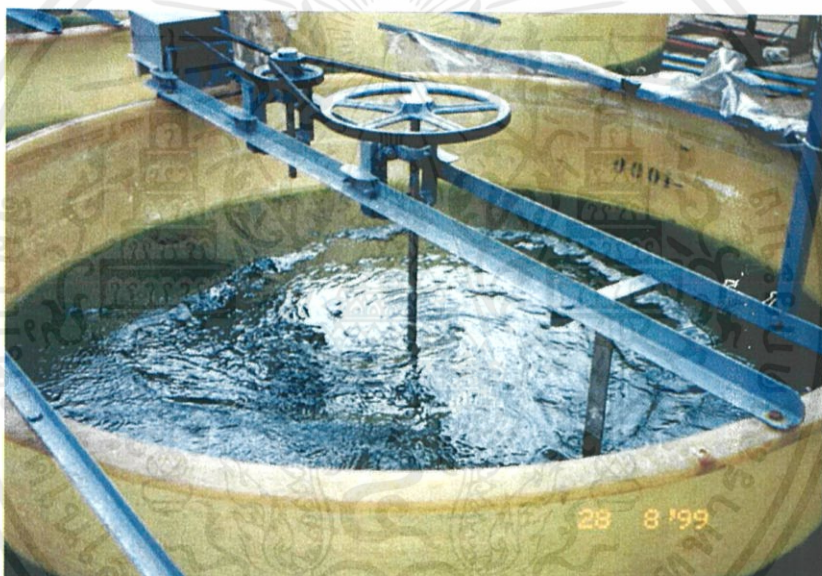
รูปที่ 4.1 ระบบการเพาะเลี้ยงสาหร่าย Hapalosiphon sp. TISTR 8252 ภายใต้สภาพกลางแจ้ง ในบ่อคอนกรีตปริมาตร 1,000 ลิตร
