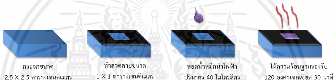
รูปที่ 3.7 แสดงขั้นตอนการเตรียมฟิล์มด้วยเทคนิคการหยด
