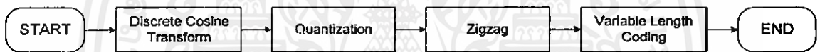
รูปที่ 2.8 แสดงบล็อกไคอะแกรมการเข้ารหัสแม็คโครบล็อกในอินทราเฟรม
