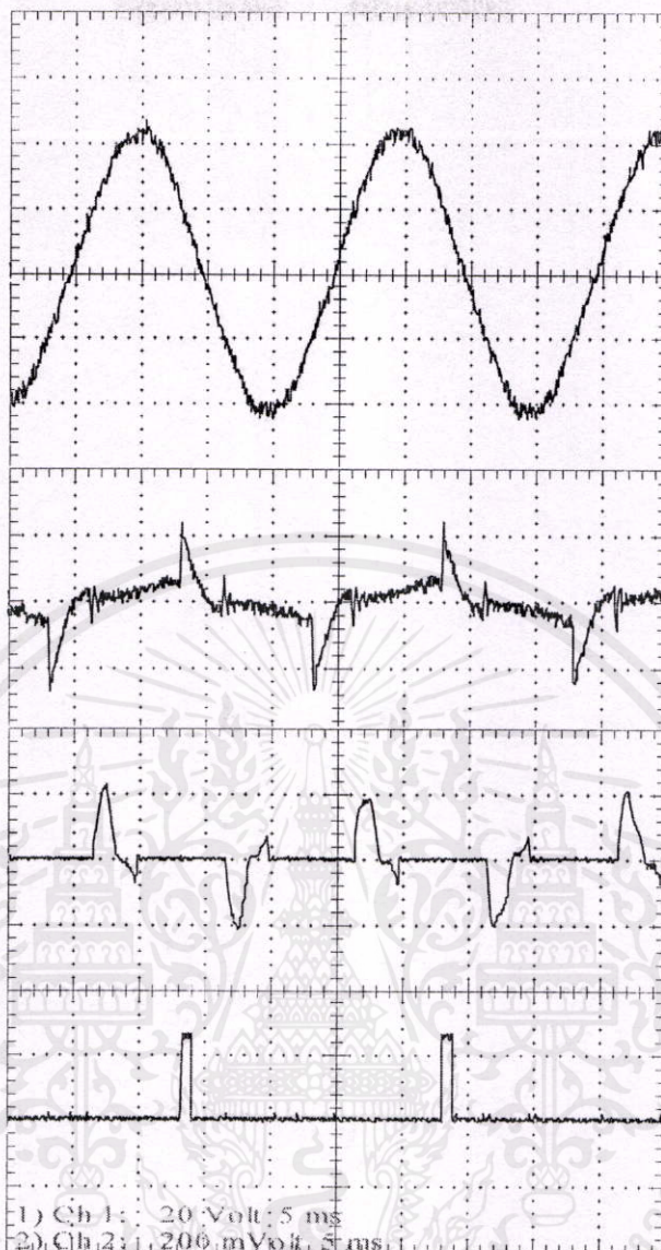
ภาพที่ 4.6 แสดงสัญญาณแรงดันที่แหล่งจ่าย , แรงดันที่มอเตอร์ , กระแสมอเตอร์ และสัญญาณกระตุ้นซิกบวทของ TCA785
