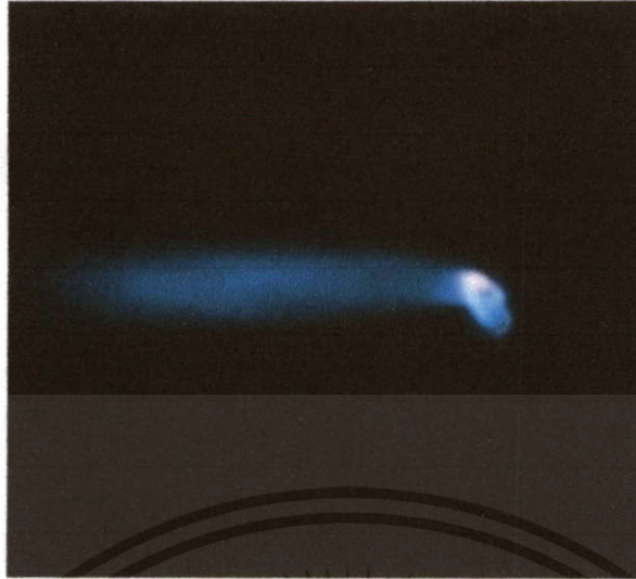
รูปที่ 4.10 สีของเปลวไฟที่ได้จากการหมักผักตบชวาขนาด 1 เซนติเมตร
