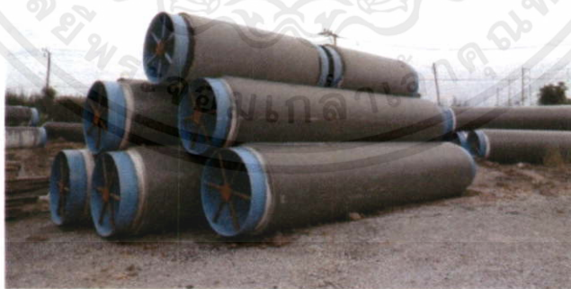
รูปที่ 4.1 ท่อเหล็กเหนียวชนิด Steel Concentric Double Cylinder Pipe \varnothing 1000 มม. สำหรับดันท่อลอด
