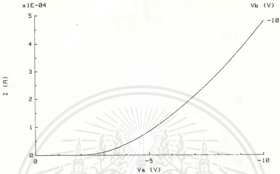
รูปที่ 4.1-5 ตัวอย่างผลการวัดค่า V_T ของ PMOSFET บนไดอะแฟรม
