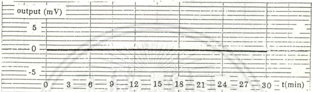
(ข) เมื่อกระแสไหลตั้งฉากกับขอบของไดโอดแฟรมที่ความดันบรรยากาศ
