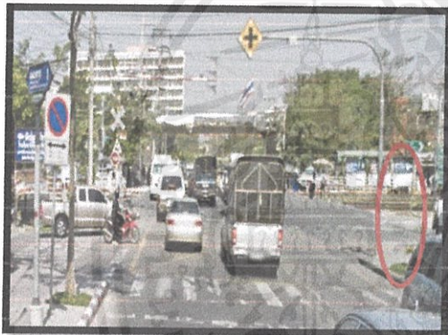
รูปที่ 4.80 จุดที่ควรแก้ไขที่ 80 บริเวณทางม้าลายข้ามถนน ไม่มีการติดตั้ง สัญญาณไฟจราจรสำหรับคนเดินเท้า ทำให้เกิด อุบัติเหตุต่อคนเดินเท้าข้ามถนนได้
