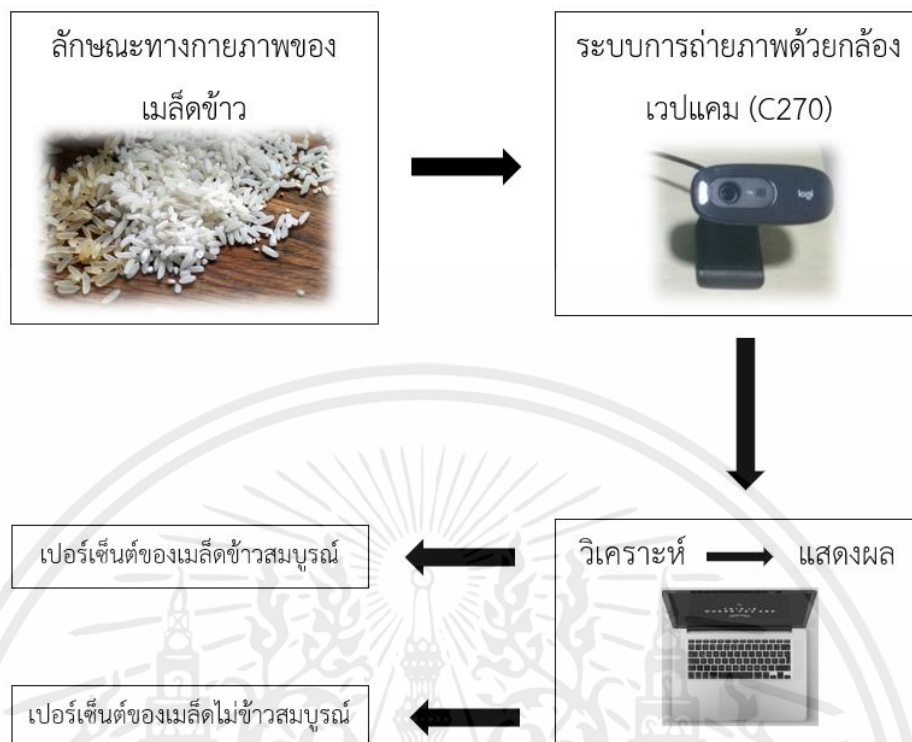
รูปที่ 3.5 Block diagram ของเครื่องตรวจวัดคุณภาพและแยกประเภทของเมล็ดข้าว
