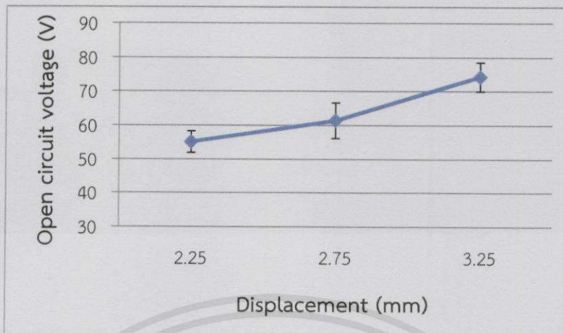
รูปที่ 4.3 กราฟเปรียบเทียบค่าความต่างศักย์ที่วัดได้โดยตรงจากเพียโซอิเล็กทริกทันเดออร์ที่ระยะโง่งตัวแตกต่างกัน
