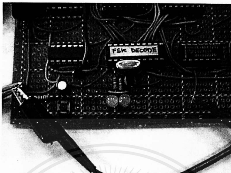
รูปที่ 5.75 แสดงการทำงานของวงจรที่ความถี่กลางเท่ากับ 3.125 kHz แสดงด้วยรหัส 00
