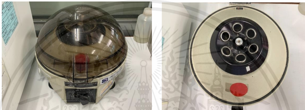
รูปที่ 4.15 เครื่องปั่นเหวี่ยงรุ่น clay adams compact II centrifuge
