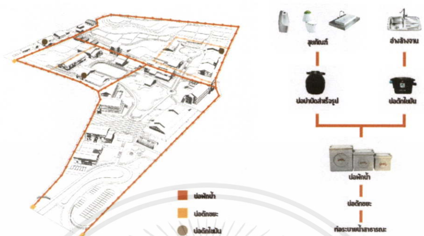
แผนภูมิที่ 8.4 แสดงงานระบบสุขาภิบาลภายในโครงการ
