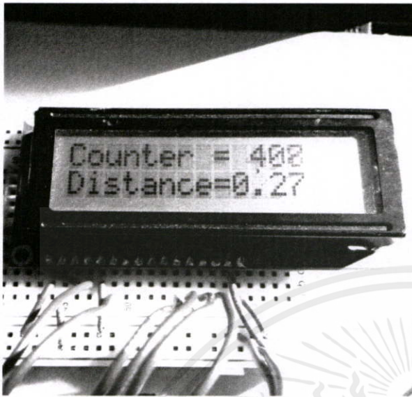
รูปที่ 4.13 การเปรียบเทียบระยะทางที่คำนวณได้จากไมโครคอนโทรลเลอร์ กับระยะทางที่แสดงที่หน้าปัดรถที่ระยะ 0.3 กิโลเมตร
