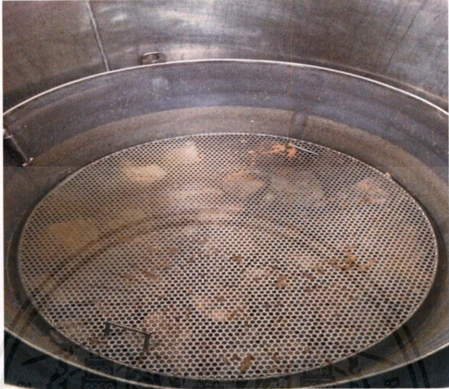
รูปที่ ค.14 การต้มสกัดในระดับขยายการทดลอง
