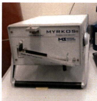
รูปที่ 2.18 เครื่อง MYRKOS Portable DGA Micro GC
