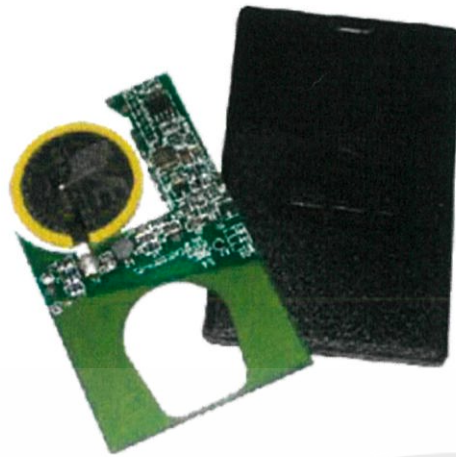
รูปที่ 2.11 ส่วนประกอบของป้าย Tag ชนิดบัตรภายในบรรจุแบตเตอรี่
