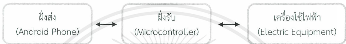
รูปที่ 3.1 บล็อกไดอะแกรมแสดงระบบของโครงการ
