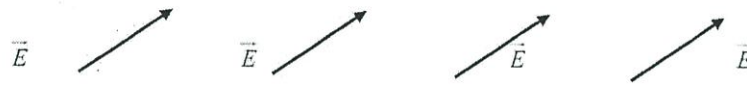
รูปที่ 2.9 การโพลาไรซ์เชิงเส้นแนวเฉียง [3]
