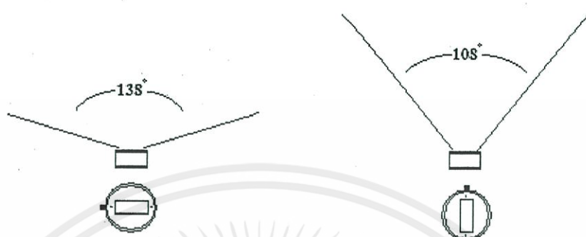
รูปที่ 4.10 ลักษณะการวาง PIR Sensor สำหรับการทดลอง
