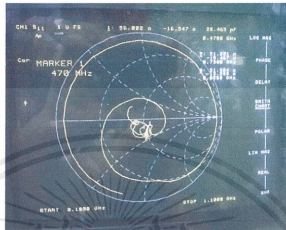
รูปที่ 4.6 ผลการวัด smith chart ของสายอากาศแถวลำดับรายคาบล็อก
