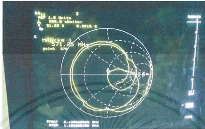
รูปที่ 4.2 ผลการวัด smith chart ของสายอากาศแบบร่อง
