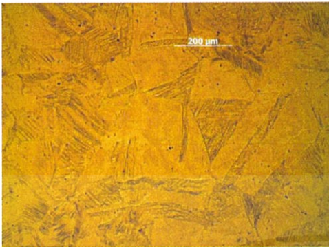
ก) อบอุ่น 850 องศาเซลเซียส 10 นาที ข) อบอุ่น 900 องศาเซลเซียส 10 นาที รูปที่ 5.3 โครงสร้างทางจุลภาคของเหล็กกล้าไร้สนิมที่ผ่านการดิงระยะยืด 40%
