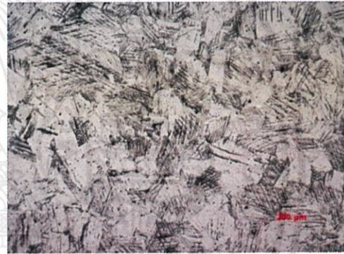
รูป ก) ไม่ผ่านการอบอ่อน รูป ข) อบอ่อน 700 องศาเซลเซียส 10 นาที รูปที่ 5.19 โครงสร้างทางจุลภาคของเหล็กกล้าไร้สนิมที่ขนาดเกรนเริ่มต้น 120 ไมโครเมตร ที่ผ่านการตั้ง ระยะยัด 40%
