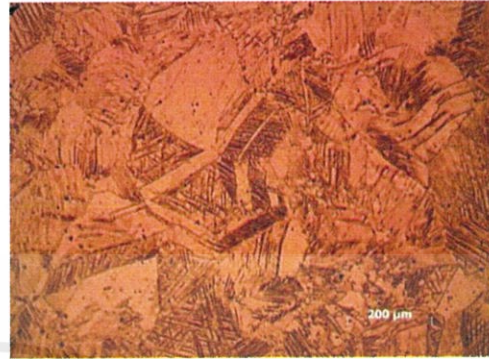
ก) อบอุ่น 850 องศาเซลเซียส 10 นาที ข) อบอุ่น 900 องศาเซลเซียส 10 นาที รูปที่ 5.3 โครงสร้างทางจุลภาคของเหล็กกล้าไร้สนิมที่ผ่านการดิงระยะยืด 40%
