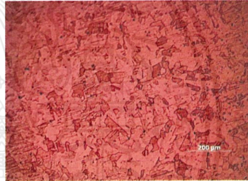
ก) อบอุ่น 950 องศาเซลเซียส 10 นาที ข) อบอุ่น 1000 องศาเซลเซียส 10 นาที รูปที่ 5.4 โครงสร้างทางจุลภาคของเหล็กกล้าไร้สนิมที่ผ่านการดิงระยะยืด 40%
