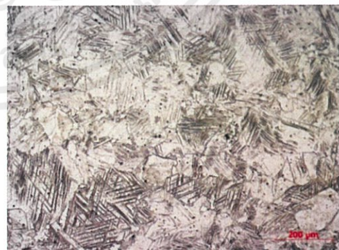
รูป ก) อบอ่อน 800 องศาเซลเซียส 10 นาที รูป ข) อบอ่อน 900 องศาเซลเซียส 10 นาที รูปที่ 5.20 โครงสร้างทางจุลภาคของเหล็กกล้าไร้สนิมที่ขนาดเกรนเริ่มต้น 120 ไมโครเมตร ที่ผ่านการตั้ง ระยะยัด 40%
