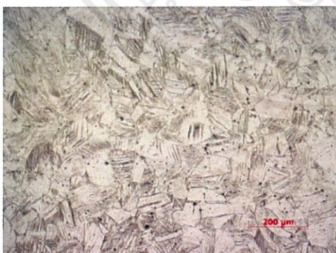
รูป ก) อบอ่อน 800 องศาเซลเซียส 10 นาที รูป ข) อบอ่อน 900 องศาเซลเซียส 10 นาที รูปที่ 5.20 โครงสร้างทางจุลภาคของเหล็กกล้าไร้สนิมที่ขนาดเกรนเริ่มต้น 120 ไมโครเมตร ที่ผ่านการตั้ง ระยะยัด 40%
