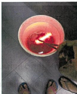
รูปที่ 4.5 ชิ้นงานในขณะที่จุ่มน้ำ (Water Quench)
