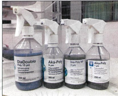
รูปที่ 4.17 แสดงลักษณะของผงขัดเพชรขนาดต่างๆ
