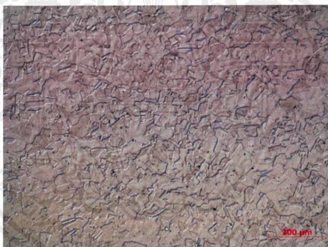
รูปที่5.26 โครงสร้างทางจุลภาคของเหล็กกล้าไร้สนิมที่ขนาดเกรนเริ่มต้น 120 ไมโครเมตร ที่ผ่านการดึง ระยะยืด 40% และอบอ่อนที่ 1010 องศาเซลเซียส 10 นาที
