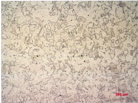
รูป ก) อบอ่อน 1000 องศาเซลเซียส 10 นาที รูป ข) อบอ่อน 1100 องศาเซลเซียส 10 นาที รูปที่ 5.18 โครงสร้างทางจุลภาคของเหล็กกล้าไร้สนิมที่ขนาดเกรนเริ่มต้น 80 ไมโครเมตร ที่ผ่านการตั้ง ระยะยัด 40%
