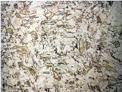
ก) อบอุ่น 950 องศาเซลเซียส 10 นาที ข) อบอุ่น 1000 องศาเซลเซียส 10 นาที รูปที่ 5.4 โครงสร้างทางจุลภาคของเหล็กกล้าไร้สนิมที่ผ่านการดิงระยะยืด 40%
