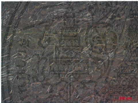
รูป ก) ไม่ผ่านการอบอ่อน รูป ข) อบอ่อน 700 องศาเซลเซียส 10 นาที รูปที่ 5.19 โครงสร้างทางจุลภาคของเหล็กกล้าไร้สนิมที่ขนาดเกรนเริ่มต้น 120 ไมโครเมตร ที่ผ่านการตั้ง ระยะยัด 40%
