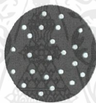
รูปที่ 2.23 ไมโครแคปซูลแบบ multi-core หรือ matrix encapsulation
