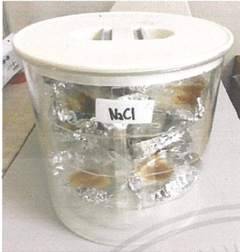
รูปที่ จ. 6 โถบรรจุสารอิมตัว NaCl
