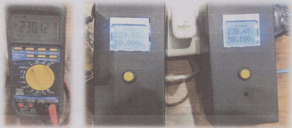
รูปที่ 4.23 เปรียบเทียบแรงดันที่แสดงบนอุปกรณ์ตรวจวัดแรงดันและความถี่ตัวที่ 2 และ 3 กับ มัลติมิเตอร์
