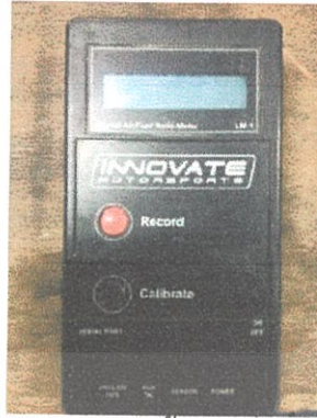
รูปที่ 3.6 เครื่องวัดอัตราส่วนอากาศต่อเชื้อเพลิง (Digital Air-Fuel Ratio Meter)
